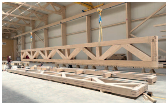
▲ Einer der drei mächtigen Fachwerkträger aus BauBuche, die für eine Kindertagesstätte in Luxemburg verwendet werden
